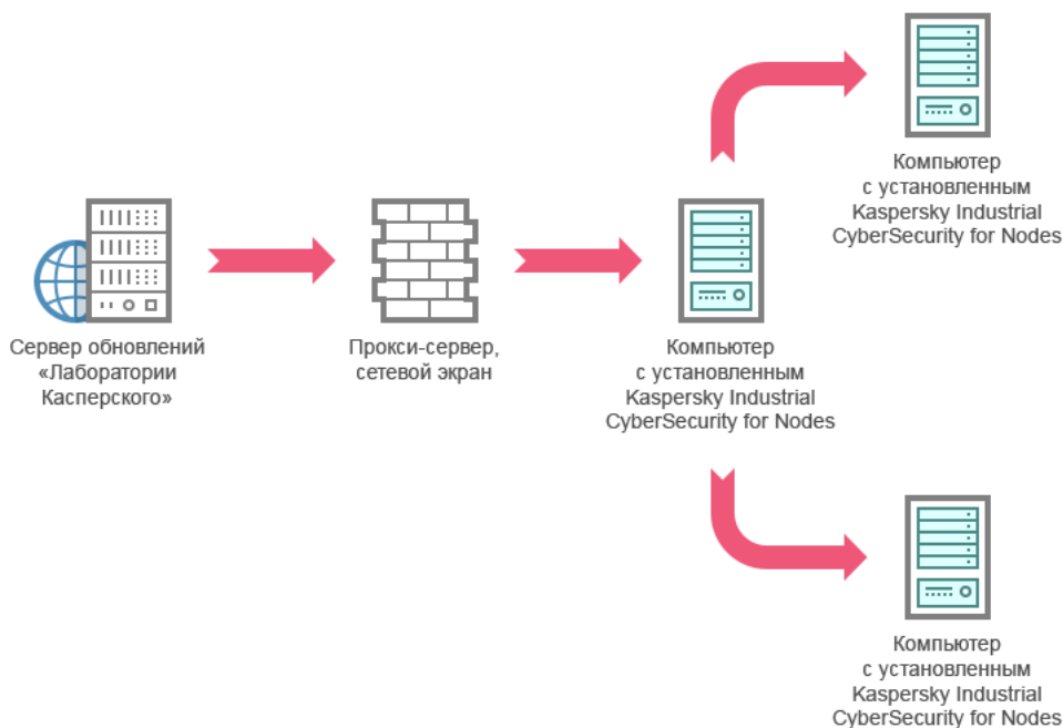
Рис. 2. Обновление баз и модулей программы через одно из защищаемых устройств
